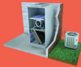
bomba de calor sistema split
